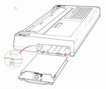
SLIDE THE CONTROL MODULE INTO THE SLOT GROOVES. IT SHOULD FIT TIGHTLY.
