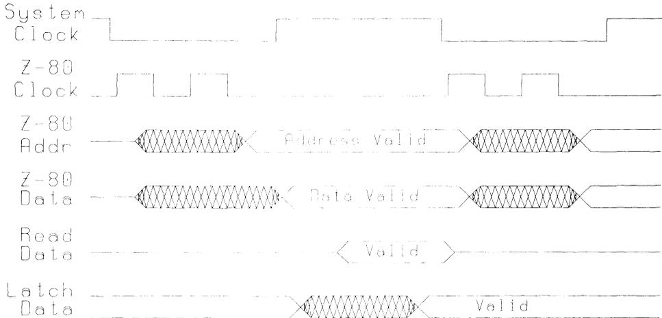
**Figure 16-6. Z80 Bus Timing**
